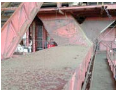
รูปที่ 5 ระบบสายพานลำเลียงเป็นระบบปิดครอบแบบมิดชิด
