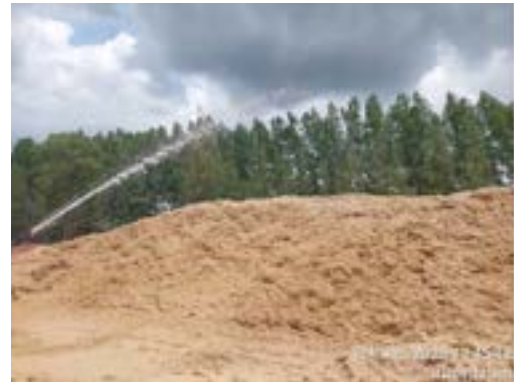
รูปที่ 54 การฉีดพรมน้ำที่ผสมสารฆ่าเชื้อราที่กองกากขานอ้อย
